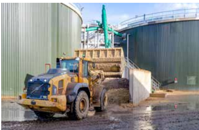
Immer in Bewegung ist der Radlader für die Fütterung mit aufbereitetem Stroh
